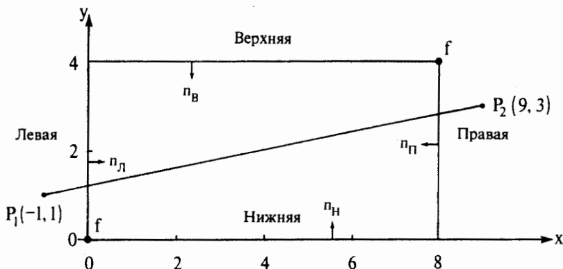
Рис. 3.12. Отсечение Кируса — Бека: частично видимый отрезок.
