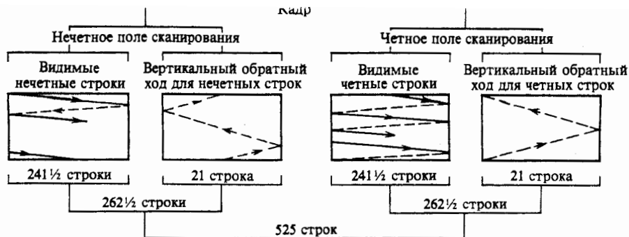
Рис. 1.20. Схема 525-строчного стандартного кадра.
